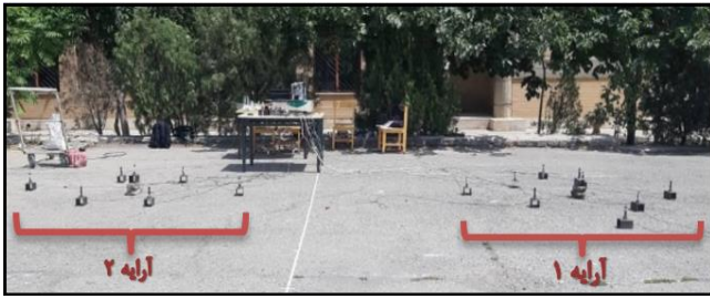
شکل ۴: معماری آرایه‌های میکروفونی مورد آزمایش در فضای باز
